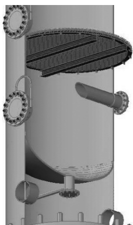
图 3.2 精脱硫塔局部模型 A(放大)
